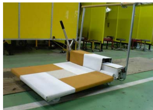
■台車 QN-217 250kg までの重い荷物を運べるように開発しました。
